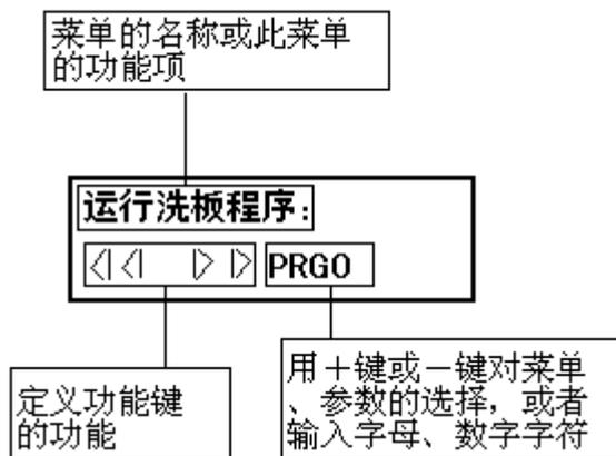
图 2-2. 洗板机 LCD 显示屏
