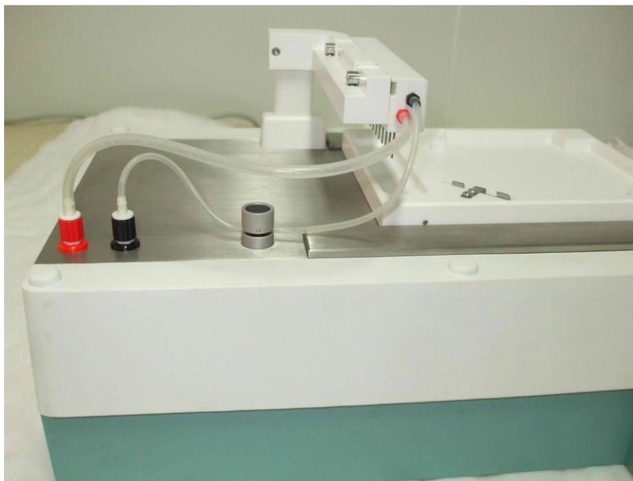
图 1-3. 注液管的连接
